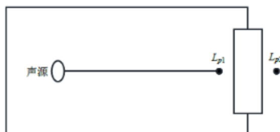
图 4.7 室内声源等效为室外声源图例
