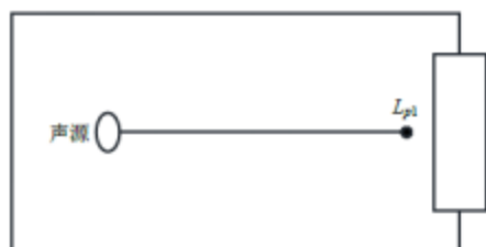
图4-2 室内声源等效为室外声源图例
