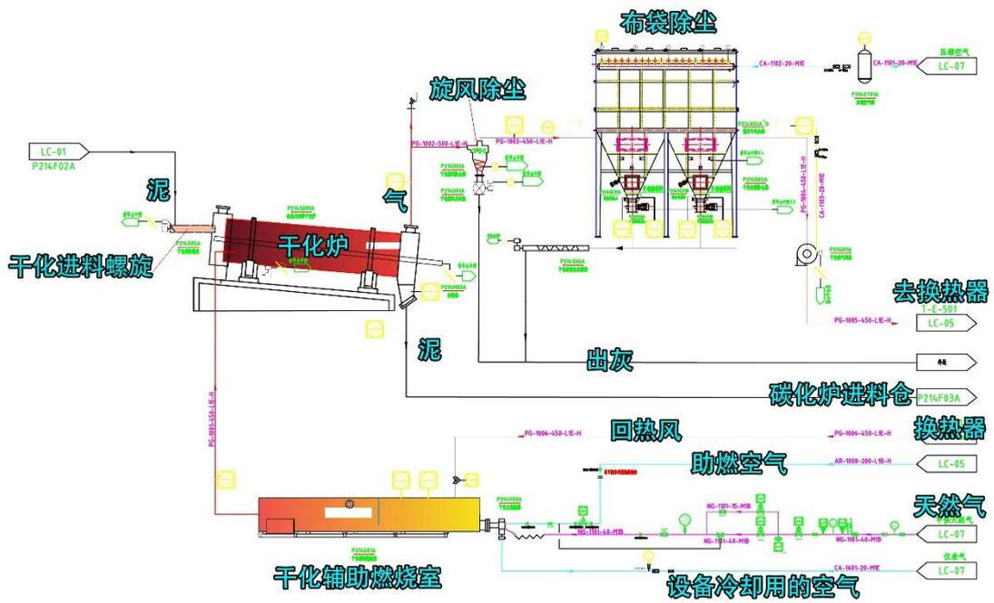
图 2-2 干化单元设备连接图
