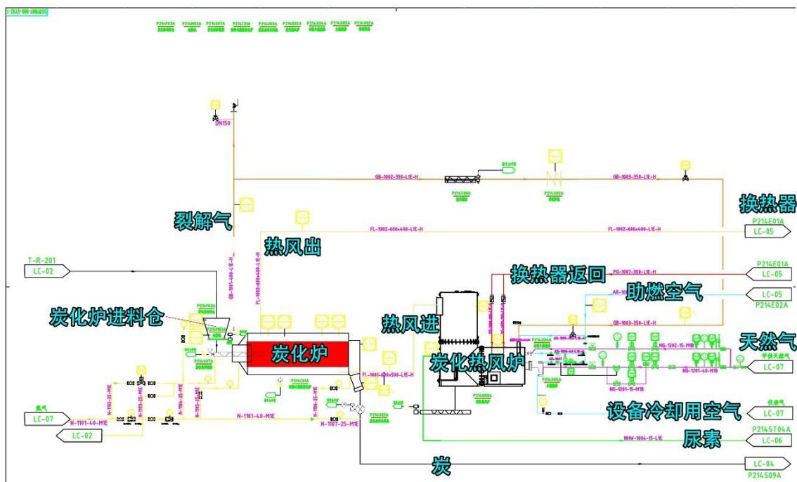
图 2-3 炭化单元设备连接图
