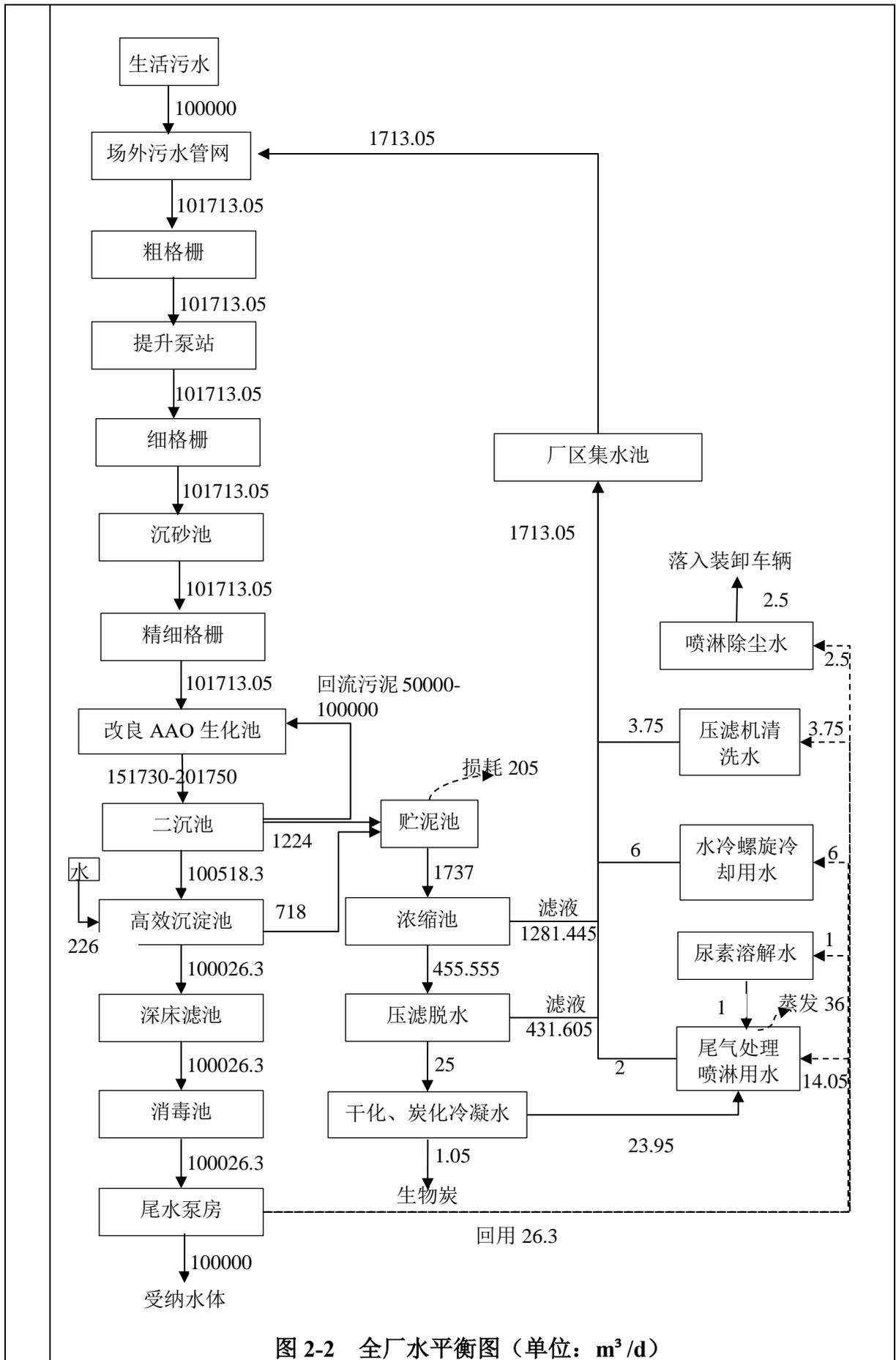
图 2-2 全厂水平衡图 (单位:  $\text{m}^3/\text{d}$ )
