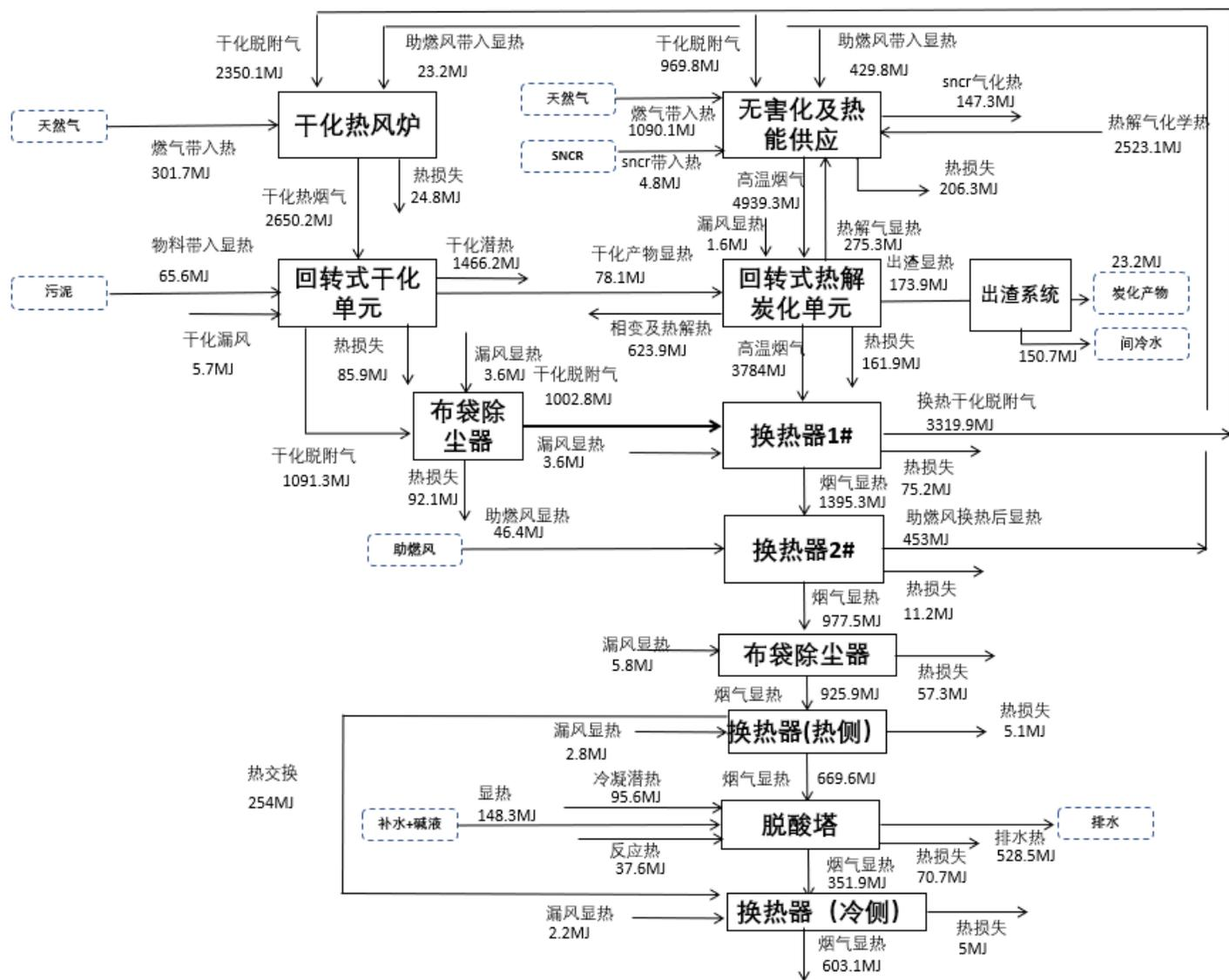
图 2-4 项目小时热量平衡图
