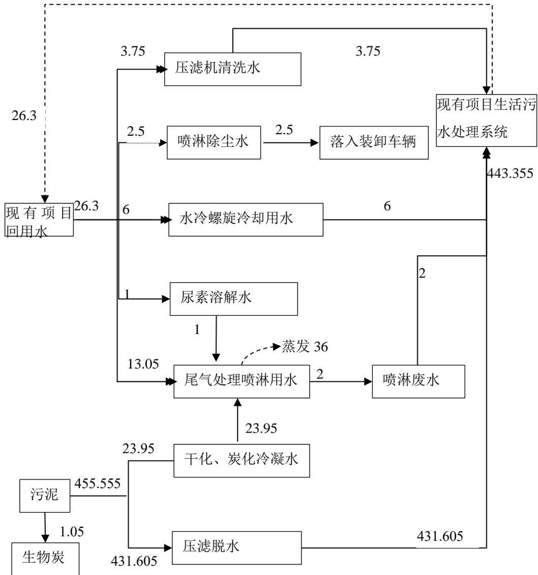
图 2-1 本项目水平衡图（单位：m³/d）
