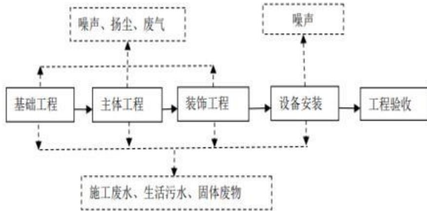
图 2-3 项目施工期工艺流程图
