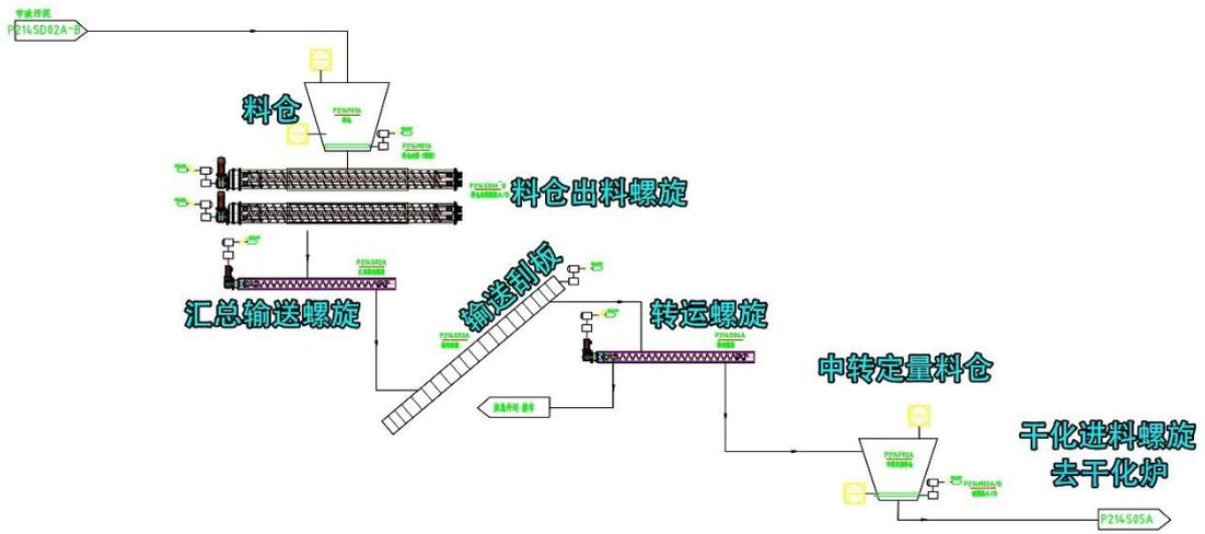
图 2-1 进料单元设备连接图
