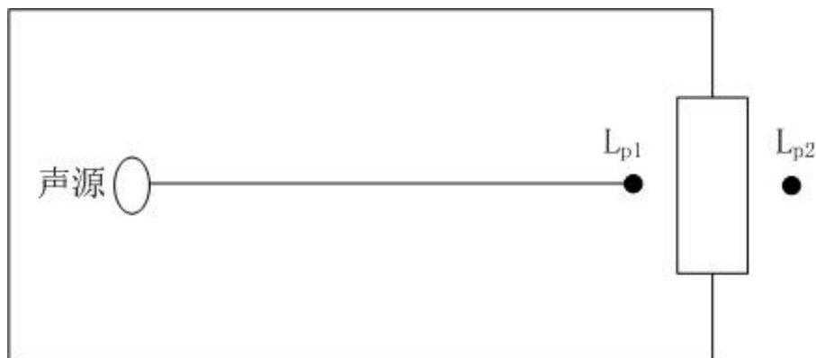
图 4-2 室内声源等效为室外声源图例
