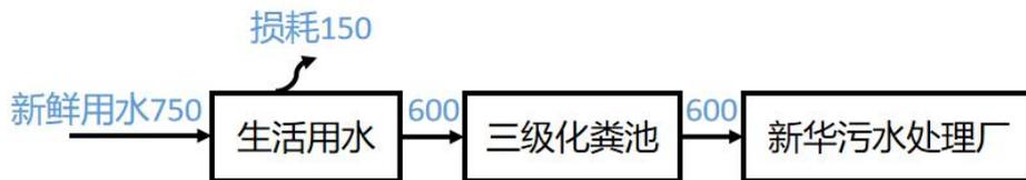
图 2-1 本项目水平衡图 (t/a)
