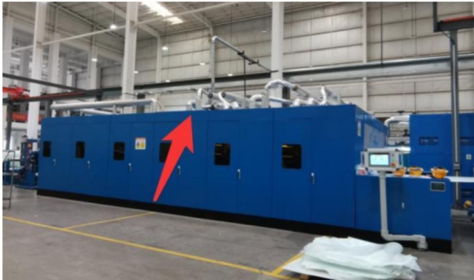
图 4-1 项目废气收集方式示意图-彩钢板（开玻璃观察窗）
