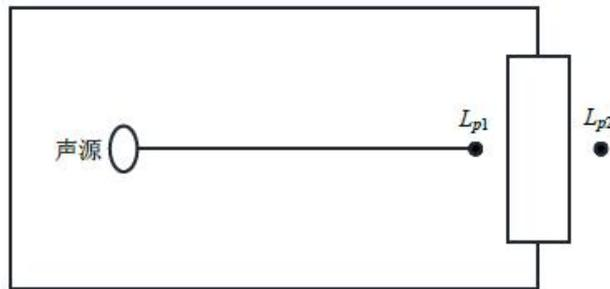
图 6.2-18 室内声源等效为室外声源图例
