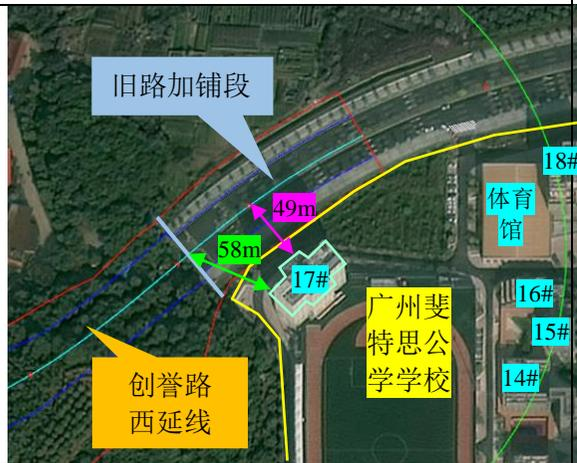
(2) 广州斐特思公学校最近建筑 17# (广州斐特思公学校高四预科楼) 位于新建创誉路西延线起点东南侧, 距创誉路西延线起点中心线最近距离为 58m, 未受到创誉路西延线水平方向交通噪声影响, 故无与创誉路西延线水平方向的剖面关系图。
