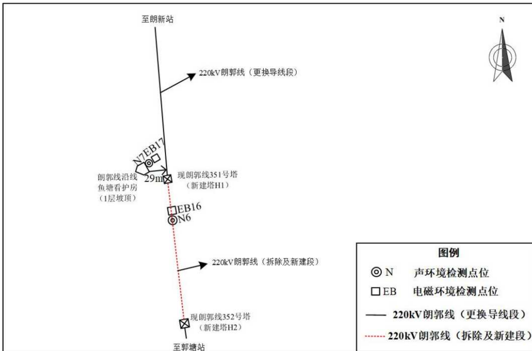
附图 16-4 本项目检测点位示意图 (220kV 朗郭线线下现状检测点、朗郭线沿线鱼塘看护房)
