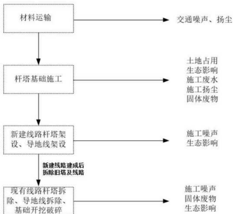
图 2.2-1 本项目施工期产污节点图
