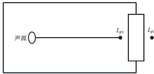
图 4-1 室内声源等效为室外声源图例
