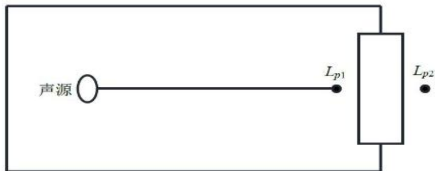
图 4-3 室内声源等效为室外声源图例
