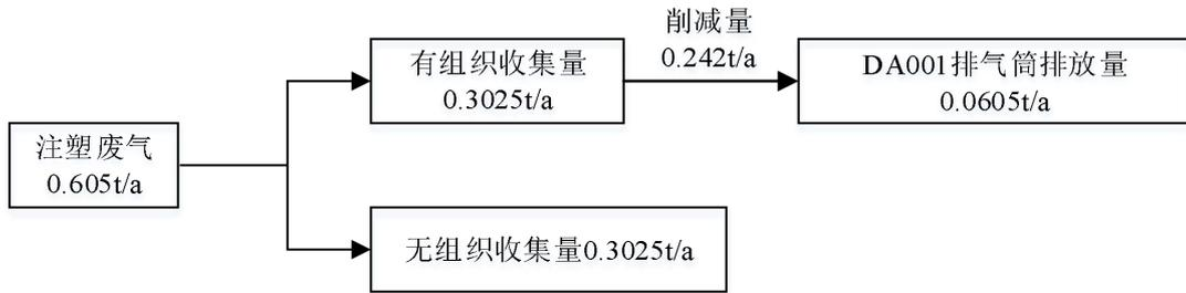
图 4-1 项目有机废气平衡图
