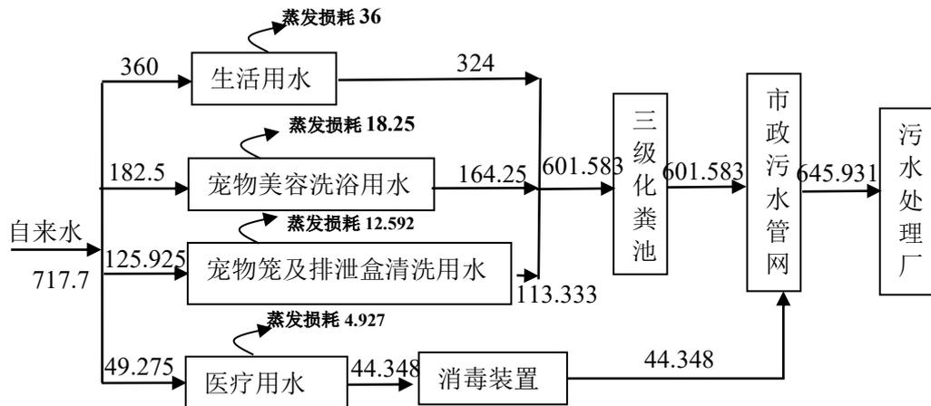
图 2-1 项目水平衡图 (m<sup>3</sup>/a)
