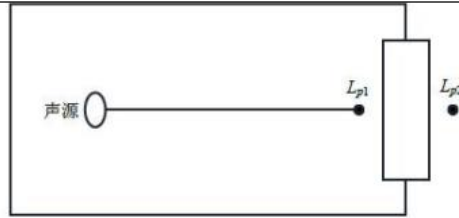
图 4-2 室内声源等效为室外声源图例
