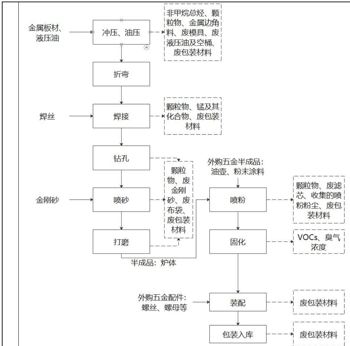
图 4 取暖炉生产工艺流程及产污环节图
