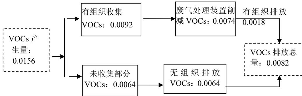
图 1 项目 VOCs 平衡图（单位：t/a）
