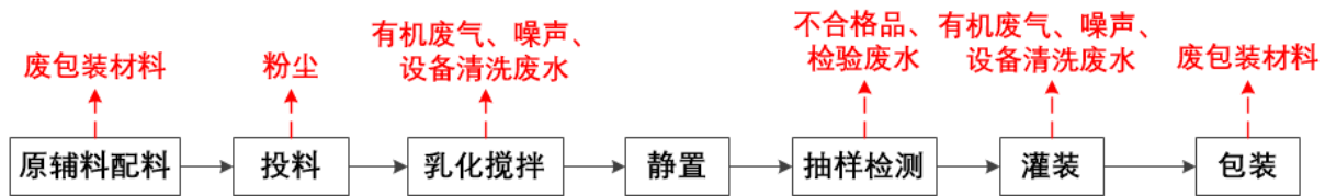
图 3.2-2 洗发水、护发素、沐浴露、洗面奶主要生产工艺流程及产污环节图
