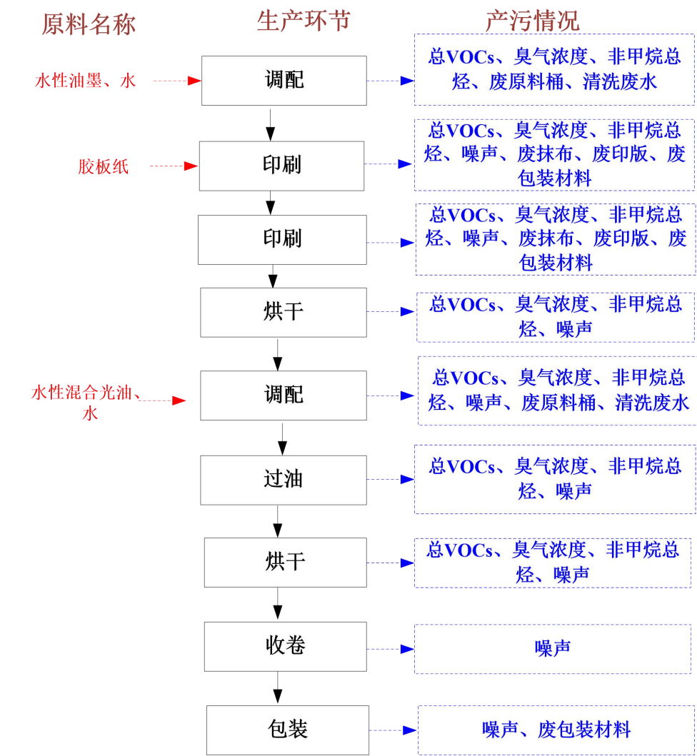
图 2-3 项目亮面纸工艺流程图
