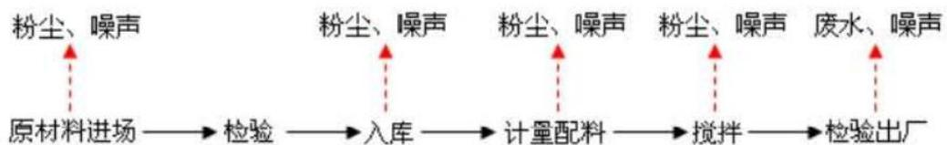
图 2-2 本项目生产工艺流程及产污环节图
