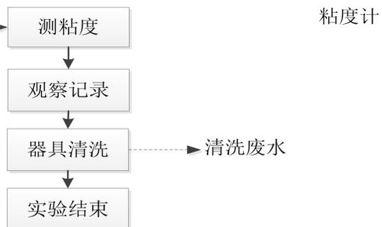
图 2-3 实验流程及产污环节图
