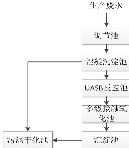
图 4-3 自建污水处理设施处理工艺流程
