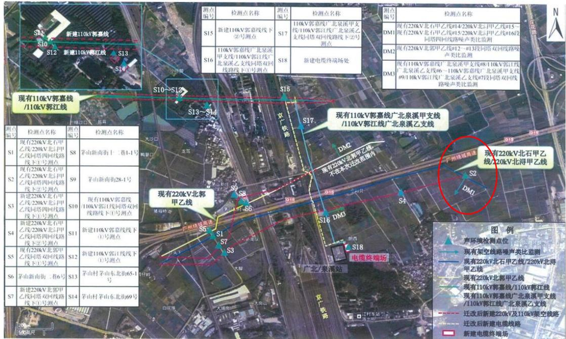
图 4-9 类比混压同塔四回架空线路噪声监测点位图
