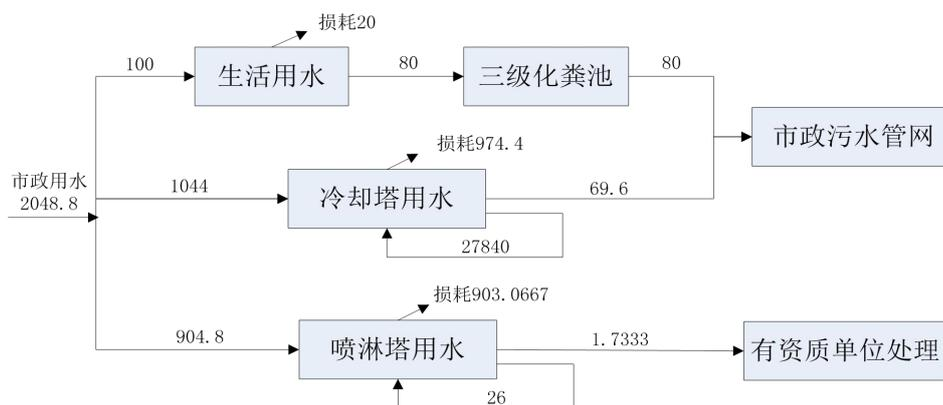
图 1 本项目全厂水平衡图（单位：t/a）
