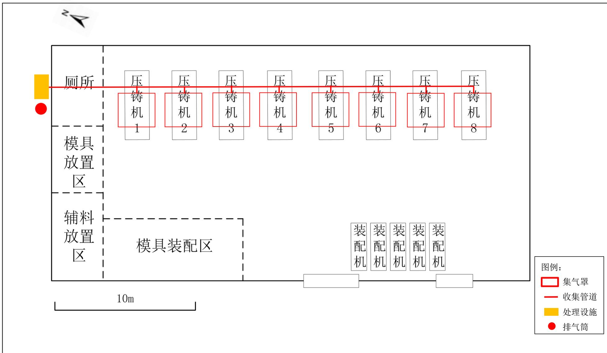
附图 8 生产车间废气收集管线图
