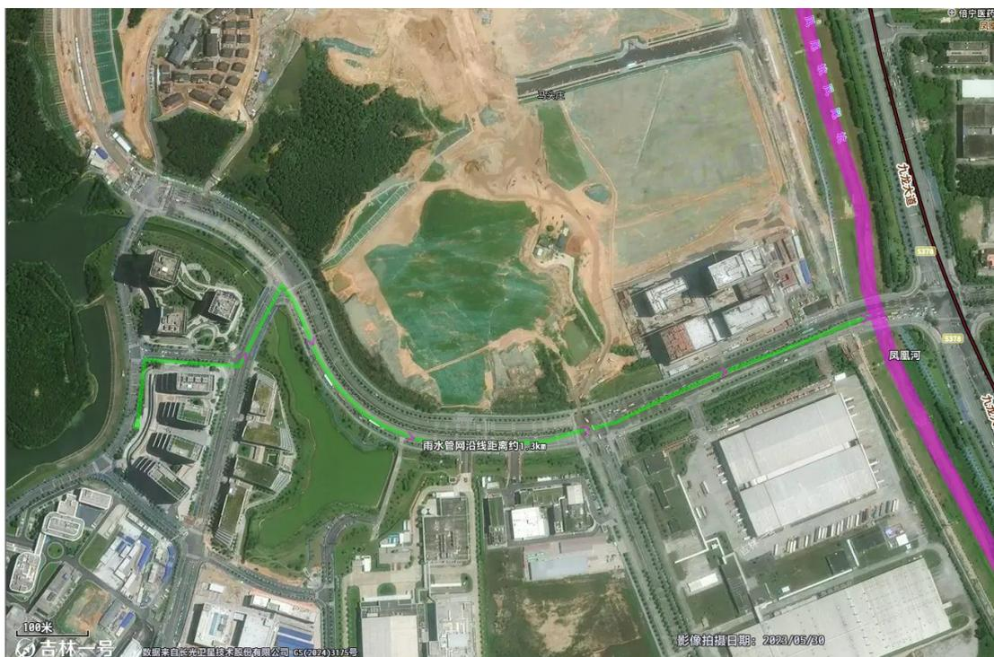
图 7.4-1 赛默飞雨水排放口经市政管网路线示意图
