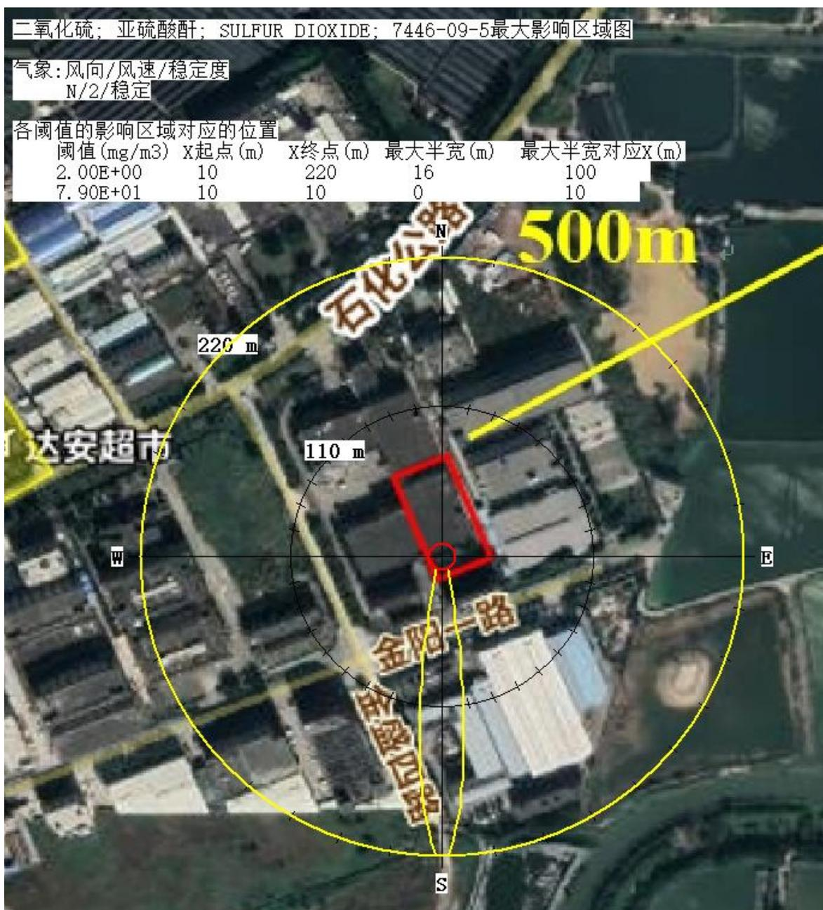
图7 火灾事故中 SO<sub>2</sub> 最大影响区域示意图
