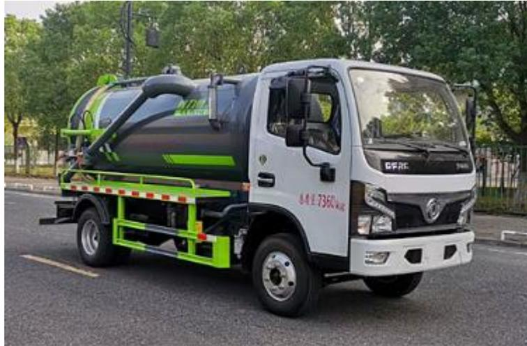
图 2-7 带抽压污泥吸污车（参考）
