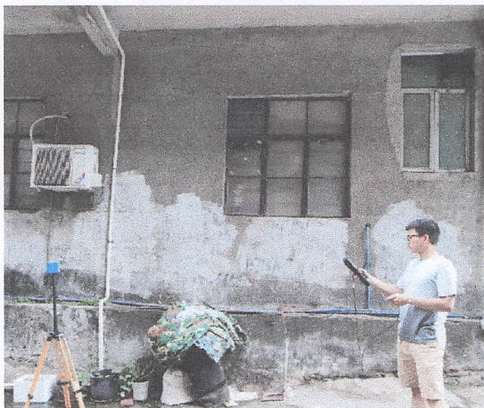
蟾蜍石北路 46 号北侧 2m 电磁环境检测照片
