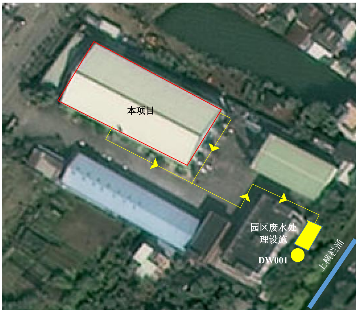
附图 5 园区生活污水管网及污水处理设施布置图
