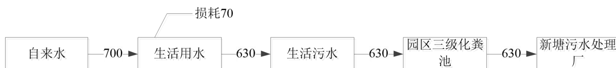
图 2-3 迁扩建后项目水平衡图 (单位 m³/a)
