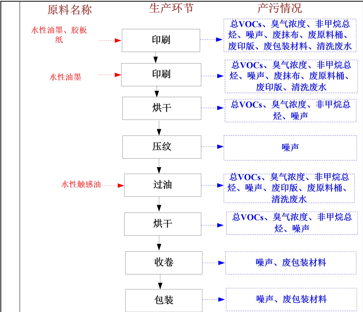
图 2-4 项目触感纸工艺流程图
