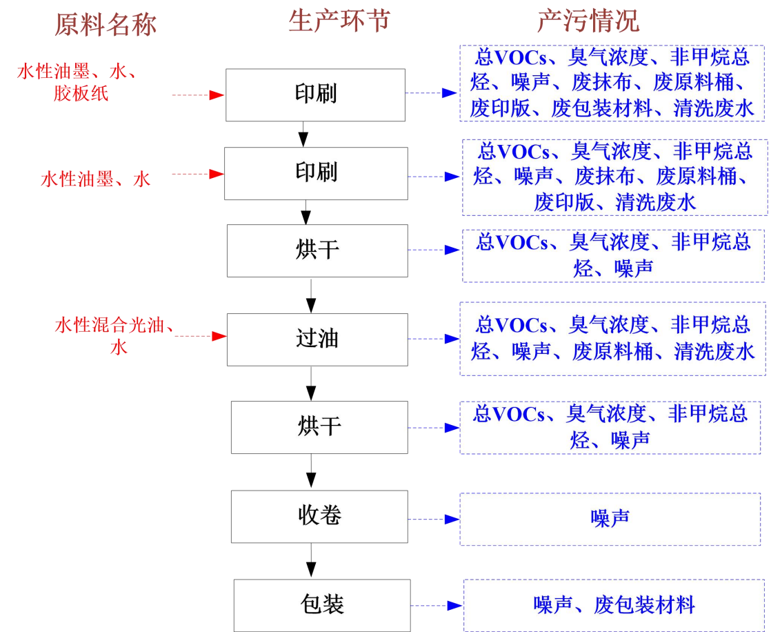
图 2-3 项目亮面纸工艺流程图
