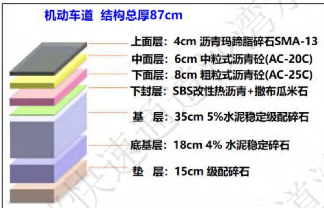
图 3.4-11 机动车道路面结构示意图
