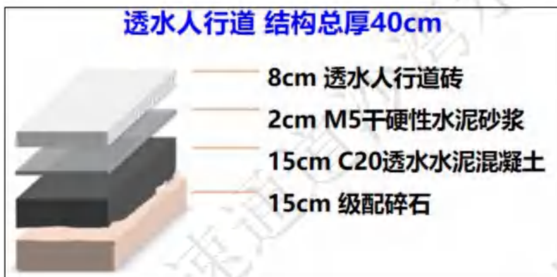
图 3.4-13 人行道路面结构示意图
