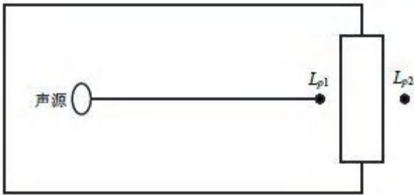
图 4-2 室内声源等效为室外声源图例
