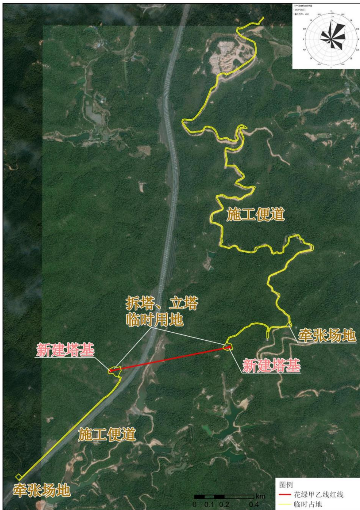
附图 17 220kV 花绿甲乙线施工平面布置图
