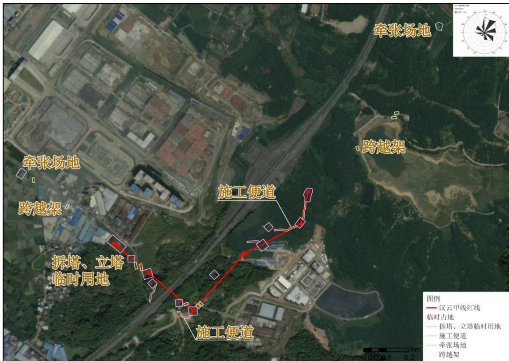
附图 18 110kV 汉云甲线施工平面布置图
