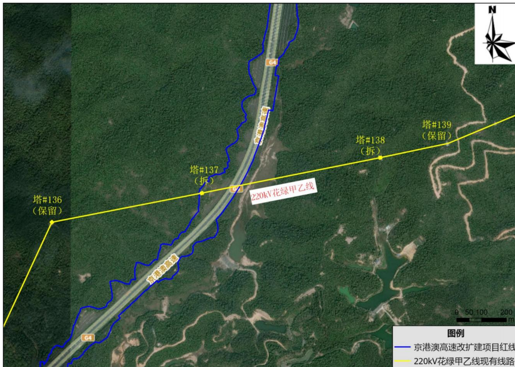
附图 5 现有工程 220kV 花绿甲乙线与京港澳高速改扩建项目红线位置关系图
