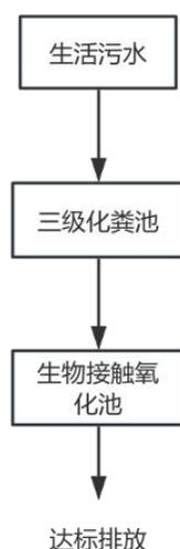
图 4-1 废水处理设施工艺流程图
