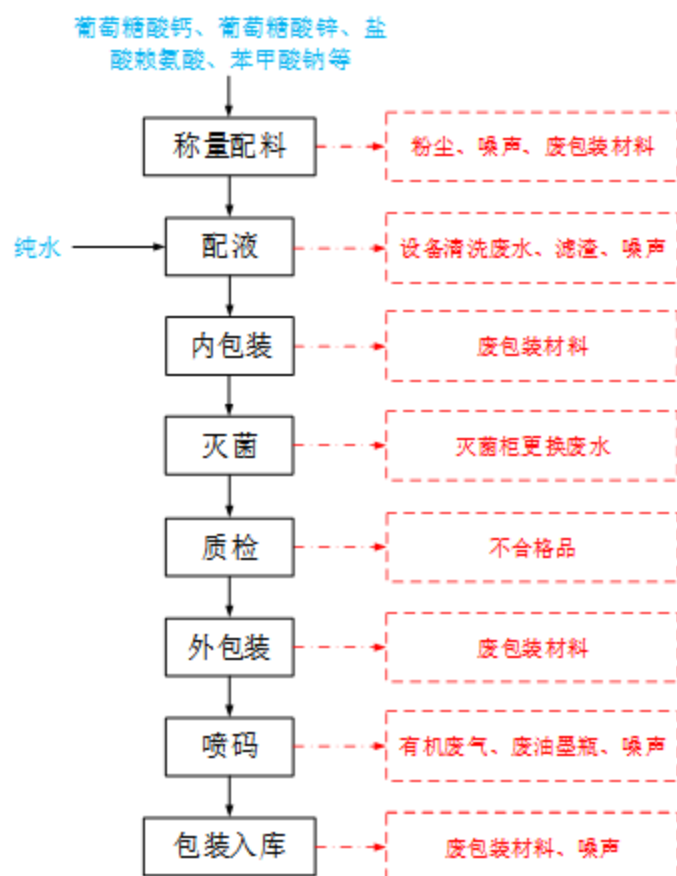
图 2-5 口服液生产工艺流程及产污环节图
