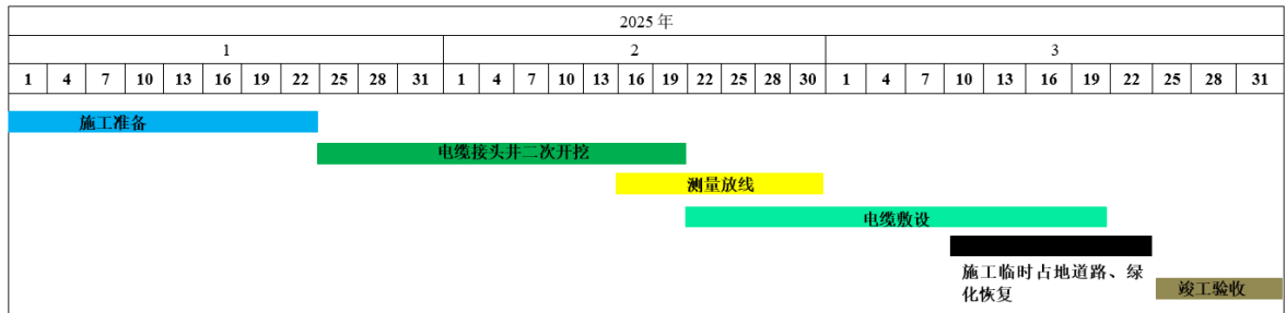
图 2-1 本工程电缆线路施工时序图
