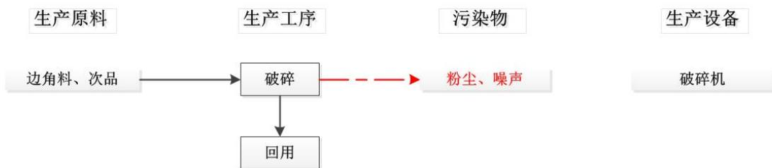
图 2-4 本项目破碎工艺流程及产污环节图
