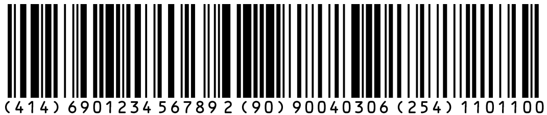
图 B.1 GS1-128 条码示例
